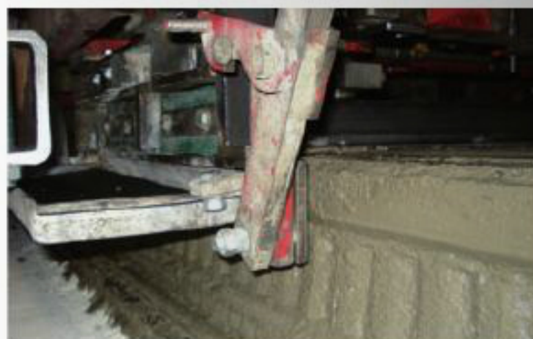
Echo Engineering stellt eine neue Lösung vor für die Fertigung einer Schubverzahnung auf der Seite von Spannbetonfertigdecken während des Produktionsprozesses der Elemente
